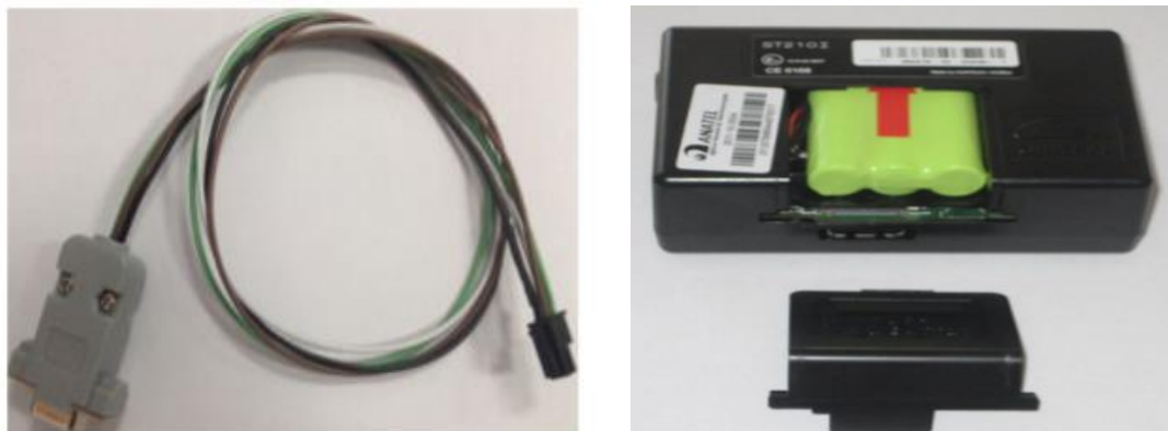
Figura 7. Módulo de Rastreamento GPS/GPRS (ST300HD)
