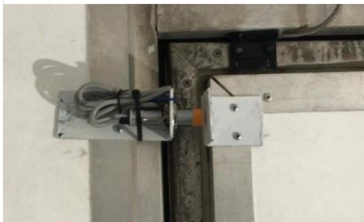
Figura 10. Sensor de Indicação de Abertura de Baú
