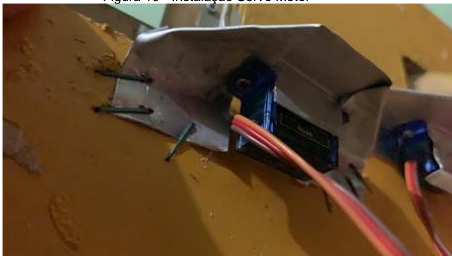
Figura 10 - Instalação Servo Motor
