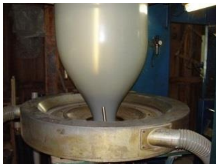
Figura 6. Matriz de uma extrusora formando um balão.
