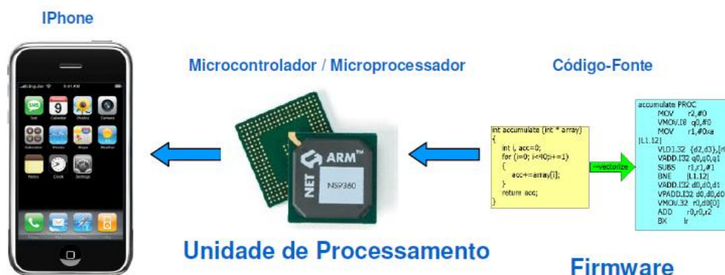
Figura 3 - Lógica de um sistema embarcado usando um microprocessador como unidade de processamento.
