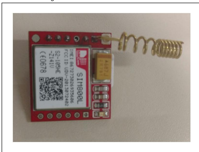
Figura 3.2 – Módulo SIMCOM SIM800L.
