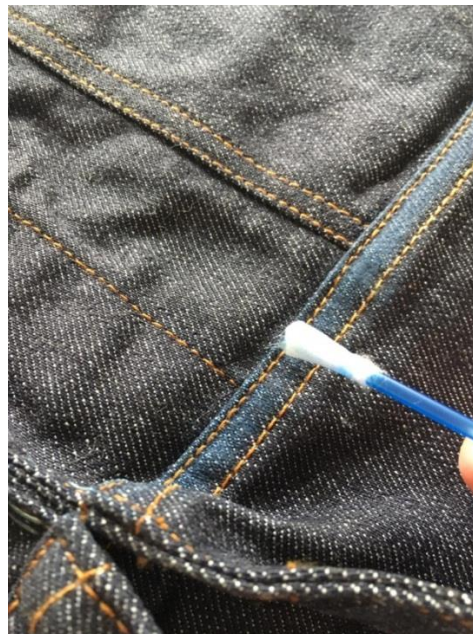
Figura 26: Aplicação de hipoclorito de sódio
