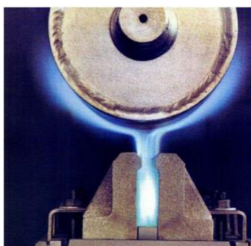
Figura 12: Fotografia de uma chamuscadeira com queimador direto (gás)
