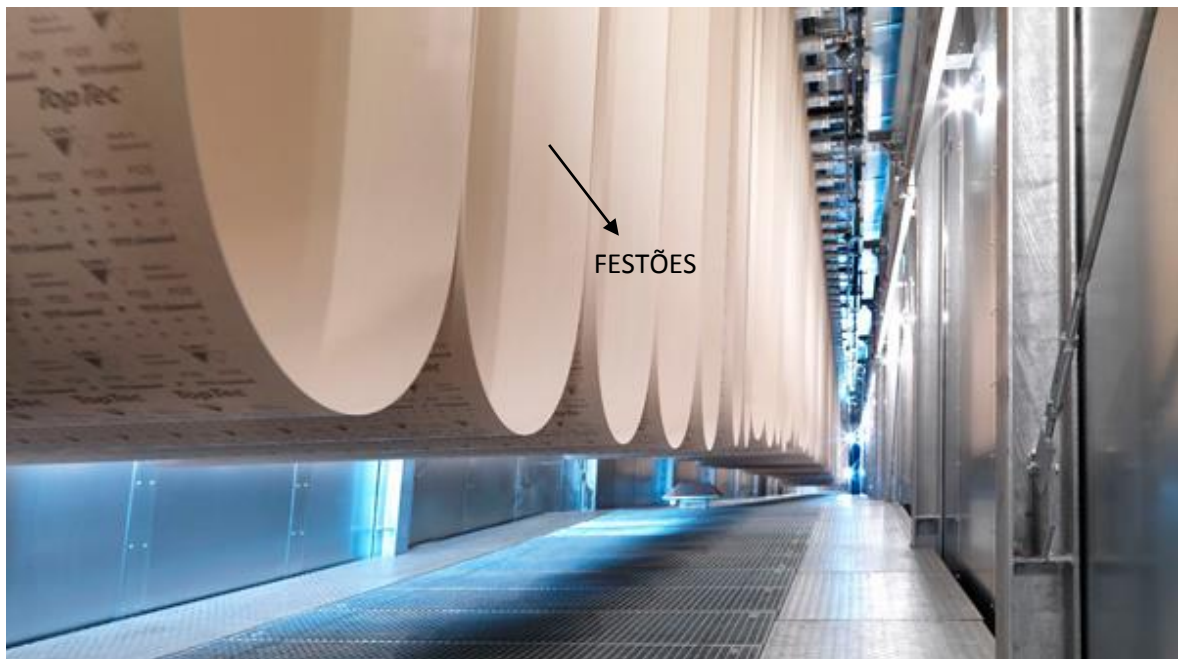
Figura 19: Festões de abrasivos revestidos dentro da estufa
