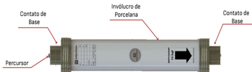
Figura 10 - Características construtivas básicas de um fusível HH
