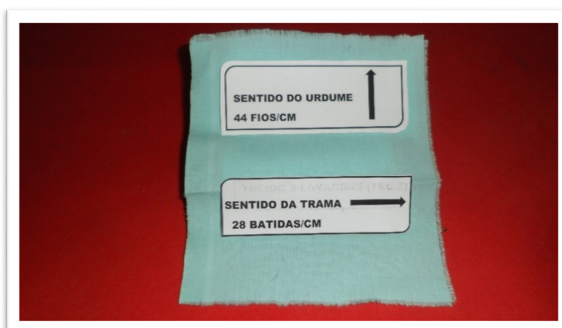
Figura 30 - Sentido do Urdume e da Trama
