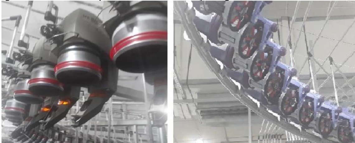
Figura 26- Alimentadores por acúmulo ou alimentação negativa
