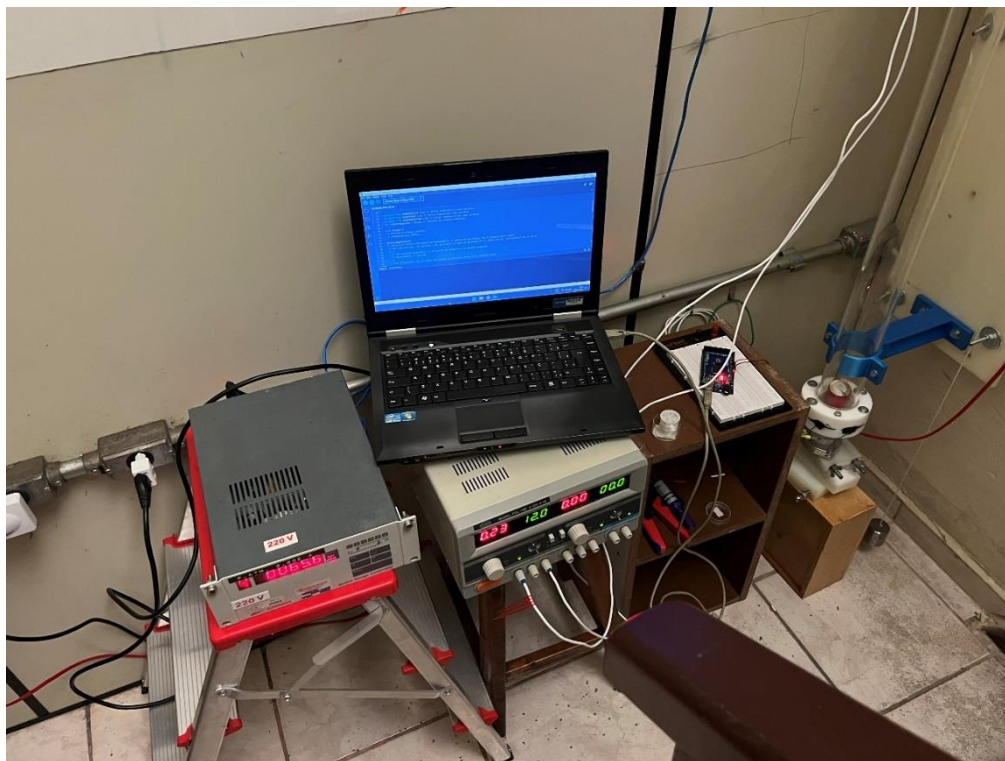
Figura 66 - Bancada utilizada durante o trabalho, contendo notebook, fonte de alimentação e visor do medidor de pressão.
