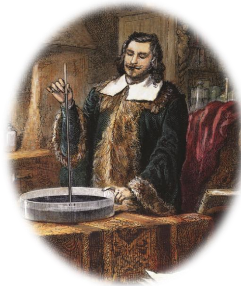
Figura 1– Ilustração de Torricelli demonstrando o funcionamento de seu barômetro de mercúrio.
