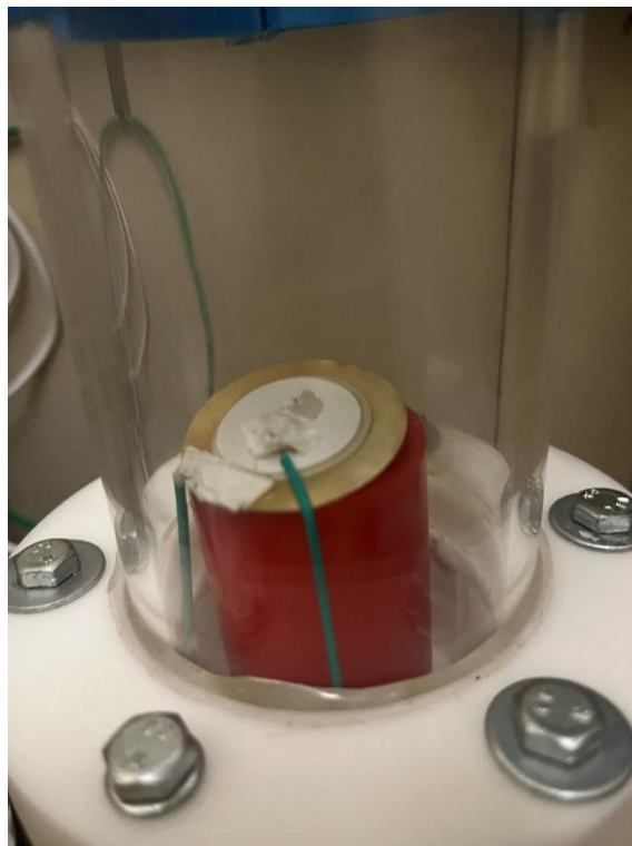
Figura 64 – Sensor piezoelétrico, danificado após a série impactos.
