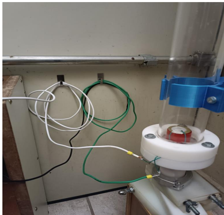
Figura 70 – Exposição do sensor piezoelétrico anexado ao arranjo.
