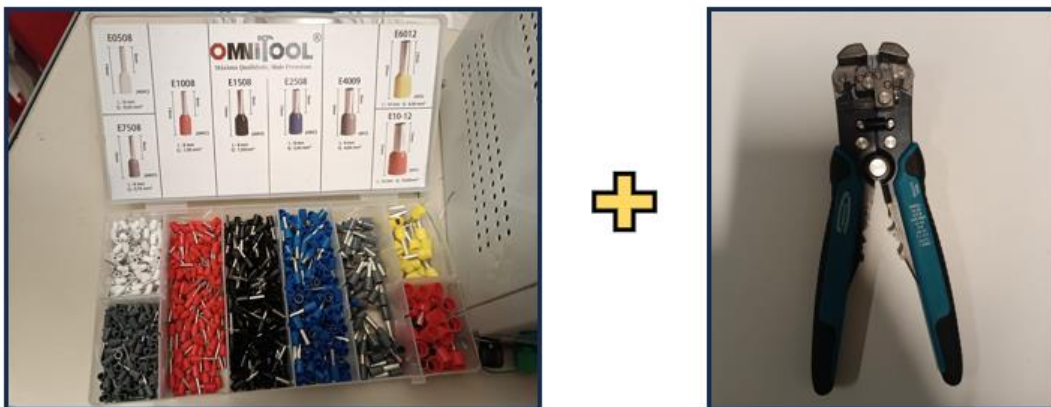
Figura 71 – Alicate e bits utilizados para a padronização dos cabos de alimentação.
