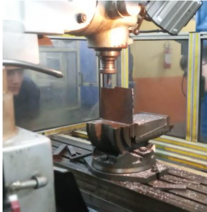
Figura 21: Processo de fresagem da chapa
