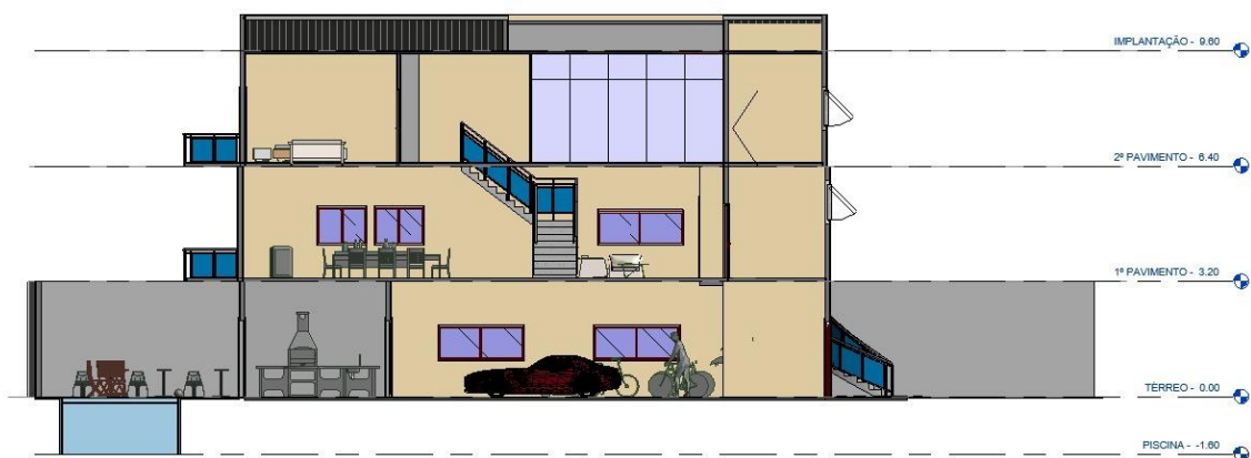
Figura 13: Projeto da residência em corte B-B. Fonte: Autores, 2024.
