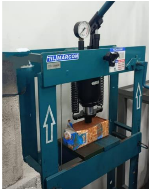
Figura 3 Equipamento para Ensaio de Compressão, utilizado nos testes de resistência do projeto
