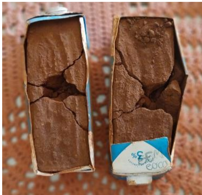
Figura 4 Tijolos após teste de resistência
