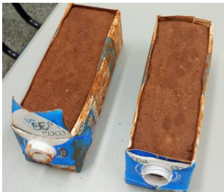
Figura 2 Tijolos após a completa secagem.
