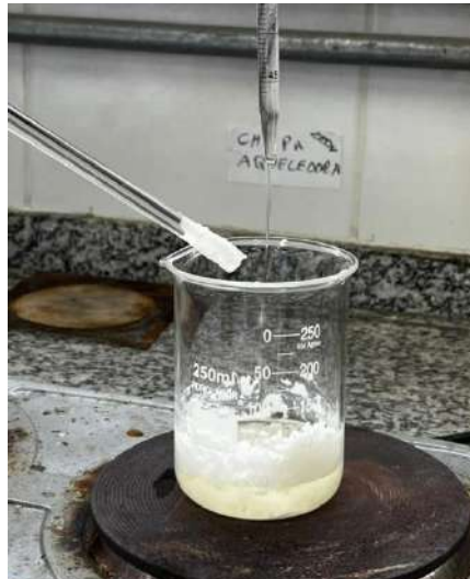
Figure 12: Adição do óleo de coco a cera já derretida
