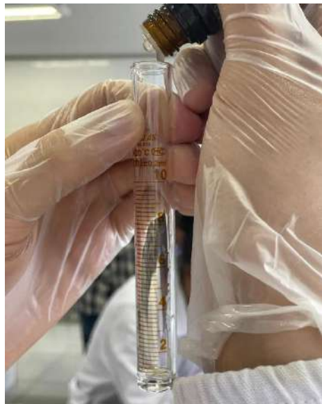
Figura 11: Medição dos óleos essenciais com auxílio de uma proveta
