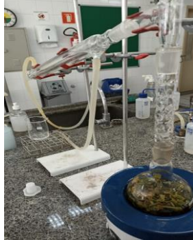
Figura 5: Extração do óleo de capim limão por destilação fracionada.
