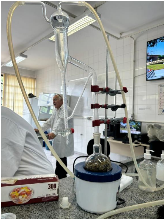
Figura 6: Extração do óleo de lavanda pelo método de clewenger.
