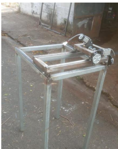
Figura 2 . Estrutura mecânica com os motores (eixo x e y):
