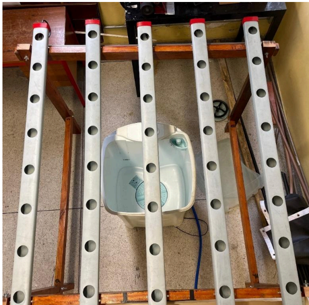
Figura 1 – Foto dos Perfis Hidropônicos.
