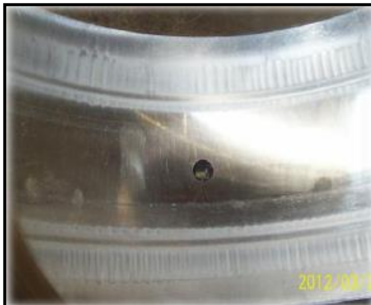
Figura 33 - Corrosão Elétrica na Pista Externa do Rolamento.
