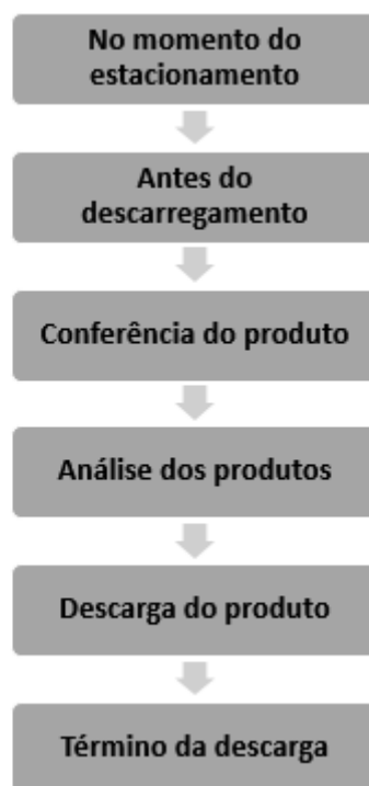
Figura 13 - Processo a ser seguido para armazenamento de combustível no Montblanc Auto Posto
