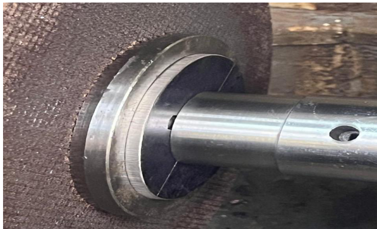
Figura 25 - Arruela que foi adicionada.
