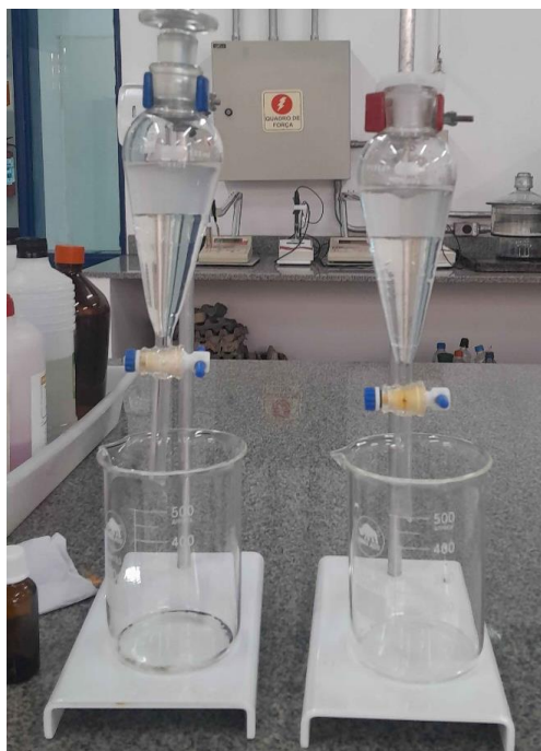
Figura 6 - Sistema de Decantação.
