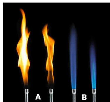
Figura 15 - Reação de combustão completa e incompleta.
