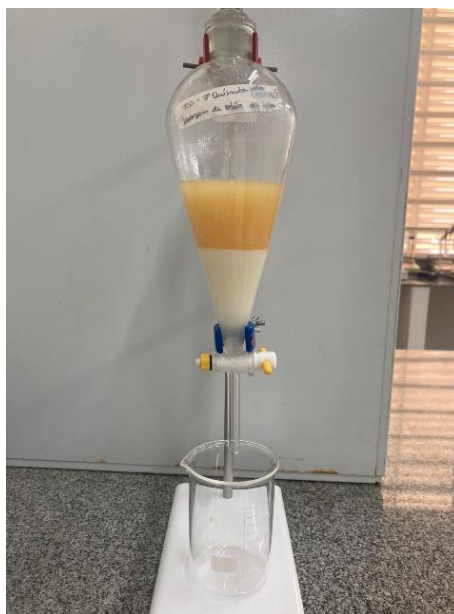
Figura 7 - Processo de decantação do óleo de soja.
