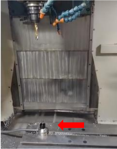
14- Eixo Z desce aproximando a ferramenta para tomada do pressete
