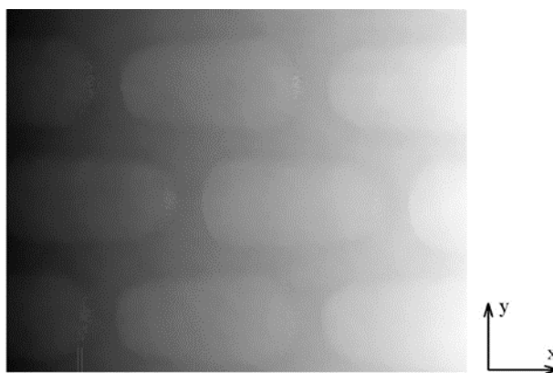
Figura 14 – Fase reconstruída da textura L pela técnica de phase unwrapping
