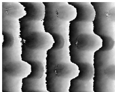
Figura 12 - Mapa de fase calculado a partir dos quatro interferogramas da textura L
