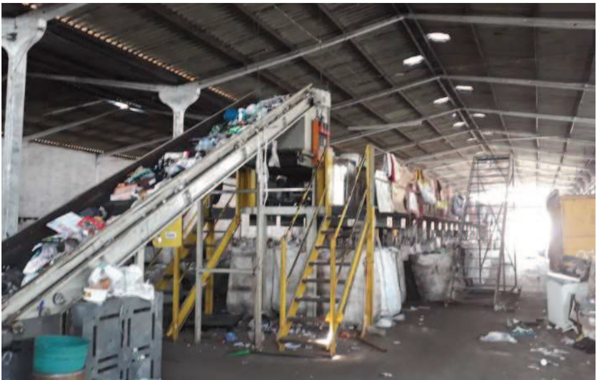
Figura 22: Esteira ergonômica de triagem manual com os bags embaixo.
