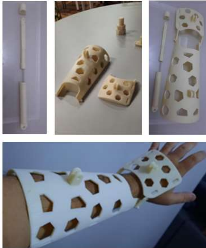
Figura 16: Verificação e montagem de peças
