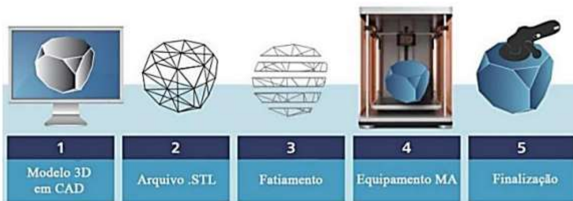
Figura 2: Etapas de processos de manufatura aditiva
