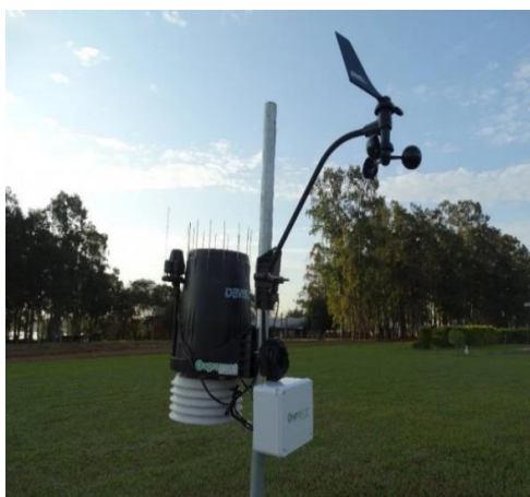
Figura 2 - Estação Meteorológica Automática
