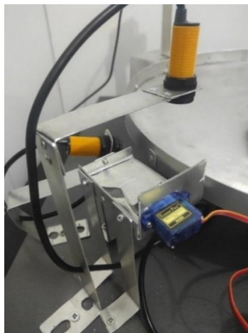
Figura 26 - Montagem do Sistema de Entrada
