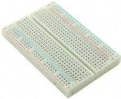
**Descrição:** Um *protoboard* é uma ferramenta de prototipagem usada para montar circuitos eletrônicos temporários. Consiste em uma base plástica com uma matriz de orifícios organizados em linhas e colunas, onde componentes eletrônicos e fios podem ser inseridos. Internamente, os orifícios são conectados por trilhas metálicas, permitindo a criação de circuitos sem necessidade de solda.
