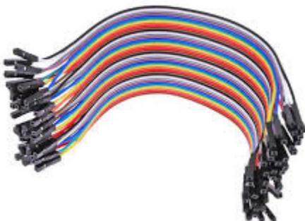
**Descrição:** Jumpers são pequenos fios ou conectores usados para estabelecer conexões elétricas temporárias em circuitos eletrônicos. Eles são frequentemente
