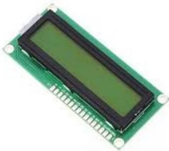
**Descrição:** O display LCD 16x2 é um tipo comum de tela de cristal líquido (LCD) usado em uma variedade de dispositivos eletrônicos. Ele consiste em 16 caracteres em duas linhas, totalizando 32 caracteres visíveis. Possui uma matriz de pontos formada por *pixels* que podem ser ativados individualmente para exibir texto, números e símbolos.
