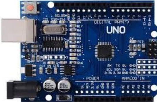
**Definição:** É um microcontrolador que controla circuitos eletrônicos, transistores e entre outros, tendo por característica ser fácil para programar, com um tipo de linguagem (c++). Facilidade para montagem é um dos pontos principais do Arduino
