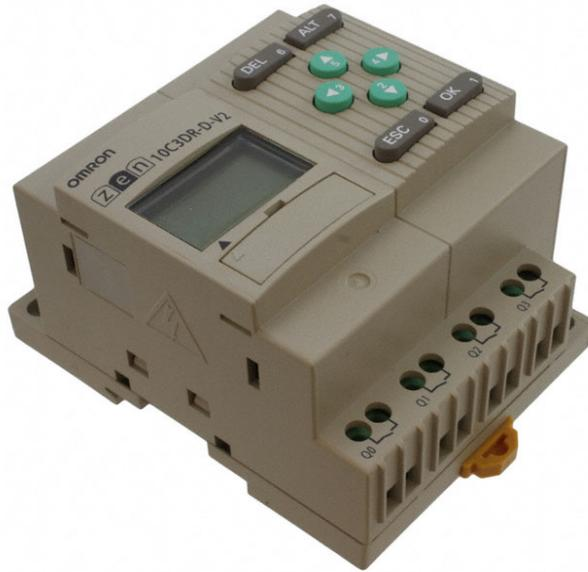
**Descrição:** O ZEN-10C3DR-D-V2 é um modelo específico de controlador lógico programável (CLP) da série ZEN fabricado pela Omron. Este dispositivo é utilizado para automação e controle em diversas aplicações industriais. Esses CLPs são conhecidos pela sua facilidade de uso, sendo uma escolha comum para pequenas automações onde a simplicidade e a eficácia são essenciais.
