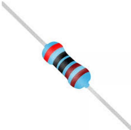
**Descrição:** Componente eletrônico passivo que oferece resistência à passagem de corrente elétrica. É geralmente feito de um material resistivo, como carbono ou metal, encapsulado em um corpo cilíndrico com dois terminais para conexão.
