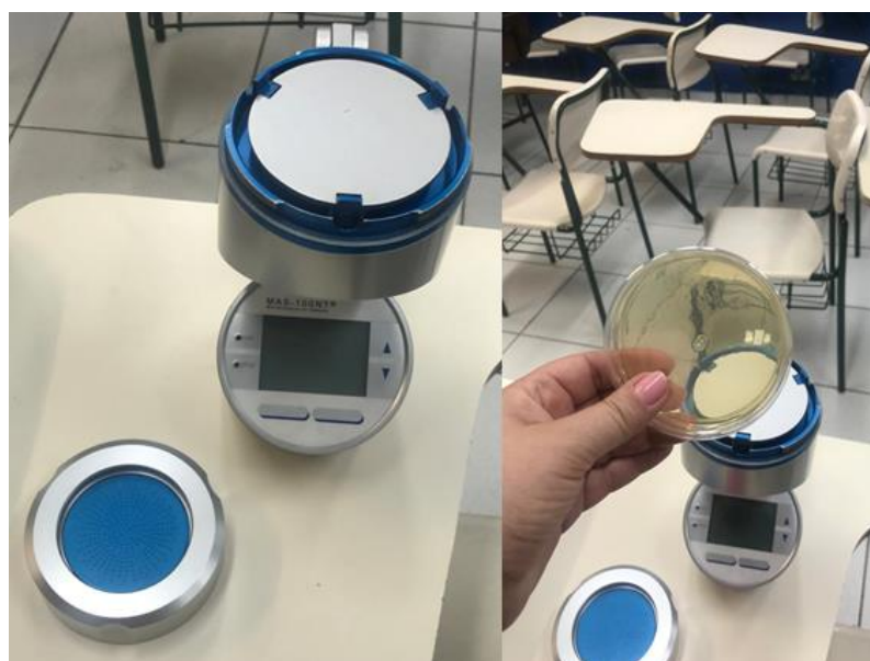
Figura 2 Coleta de amostras no amostrador microbiológico de ar MAS – 100NT (sala1 – BI2)
