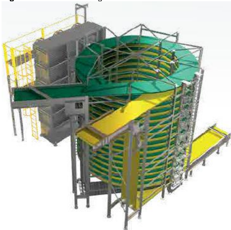
Figura 23 – Fluxo de Congelamento do Túnel Helicoidal
