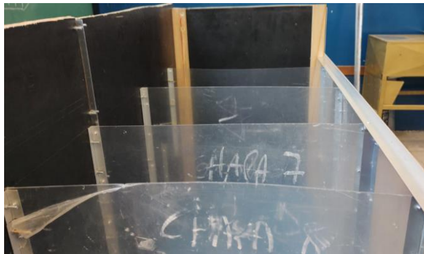
Figura 16 – Fixação dos anteparos na estrutura.
