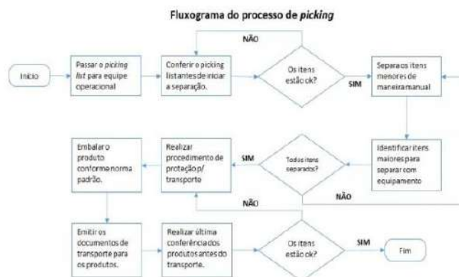
Figura 5 - Fluxograma do processo picking
