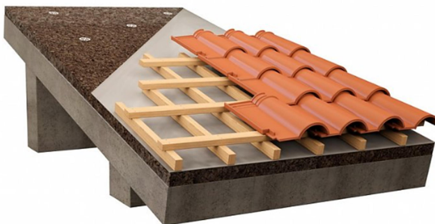
Figura 12: Aplicação do telhado em laje inclinada
