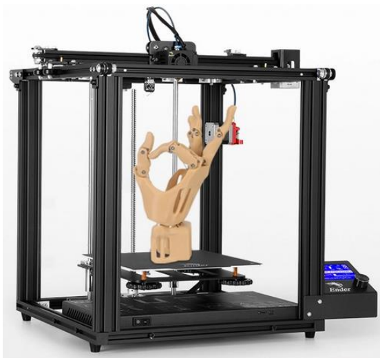
Figura 7: Impressora 3D por FDM - Modelo Ender-5 Pro da Creality
