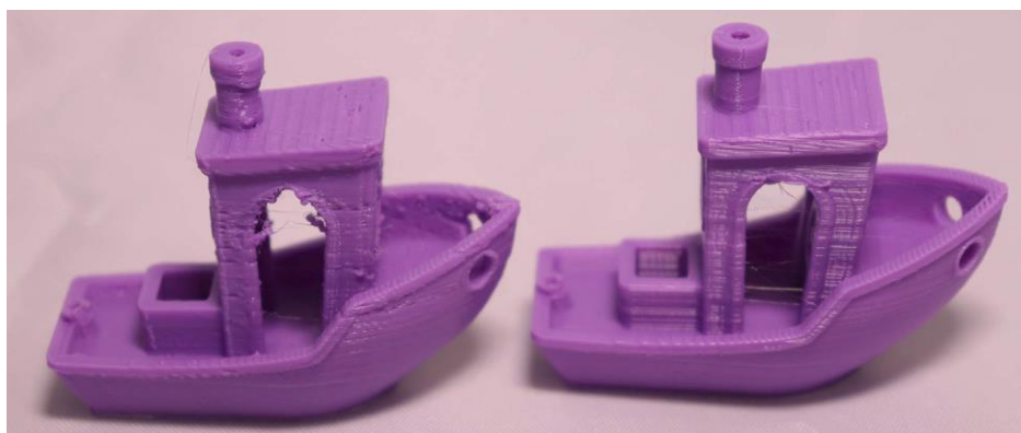
Figura 10: Bico extrusor desgastado x novo
