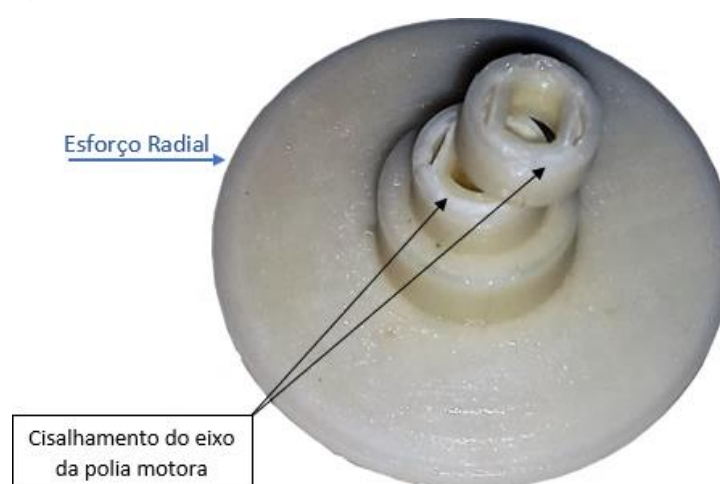
Figura 16: Cisalhamento na polia motora da versão 1
