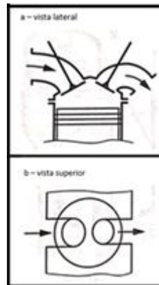
Figura 18 - Representação de cabeçote de fluxo cruzado
