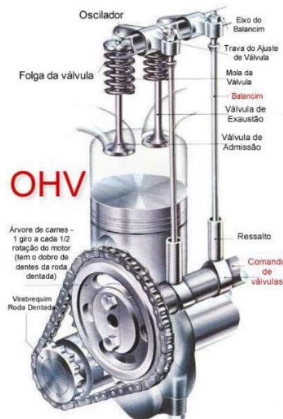
Figura 23 - Sistema de válvulas OHV
