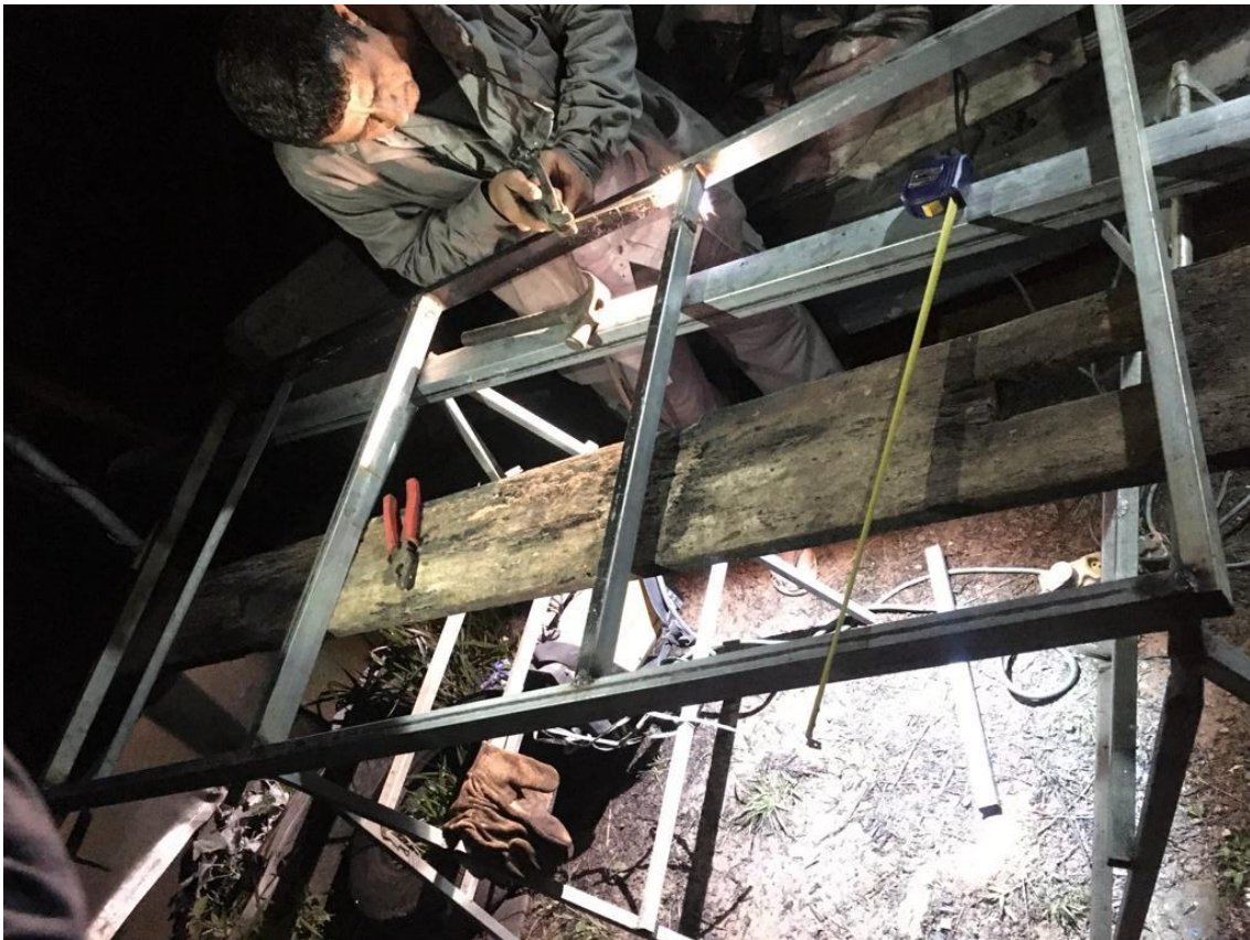
Figura 42: Chassi tipo escada – confecção
