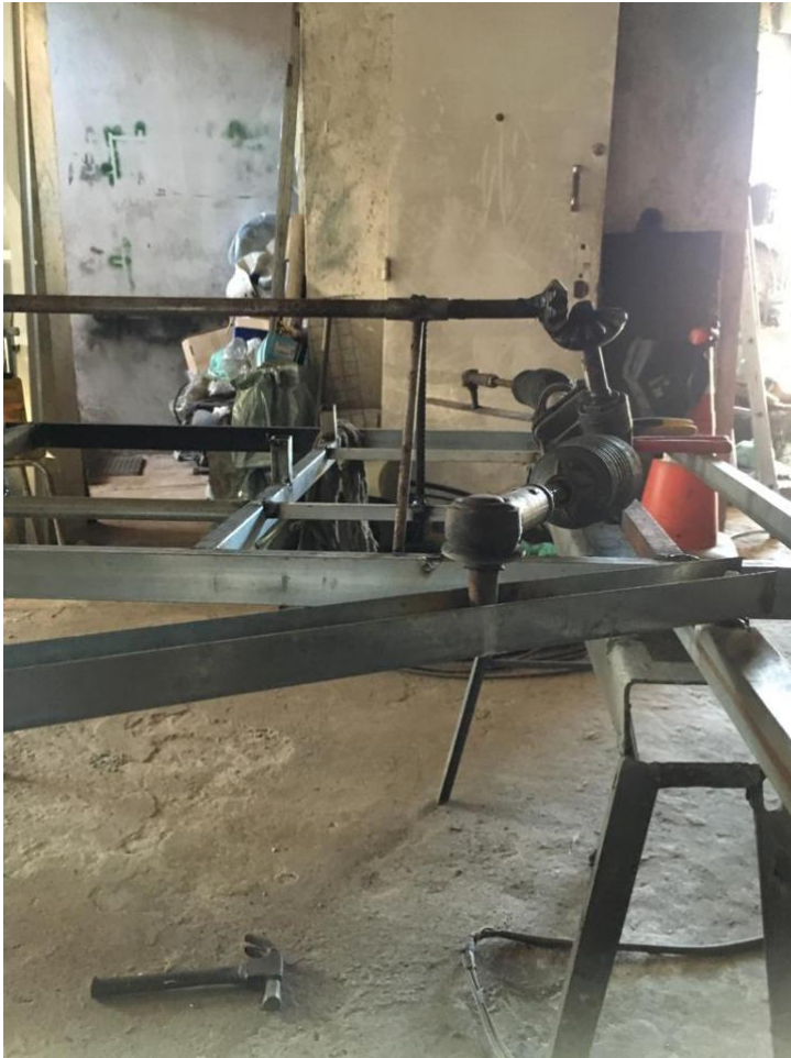
Figura 47: Visão lateral para projeto de ângulo de caster com kingpin
