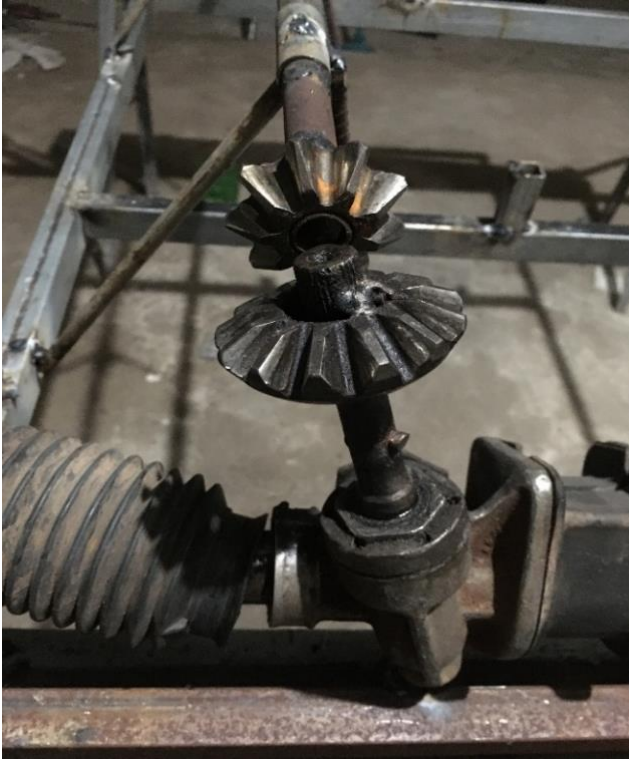
Figura 43: Foco na soldagem das engrenagens cônicas
