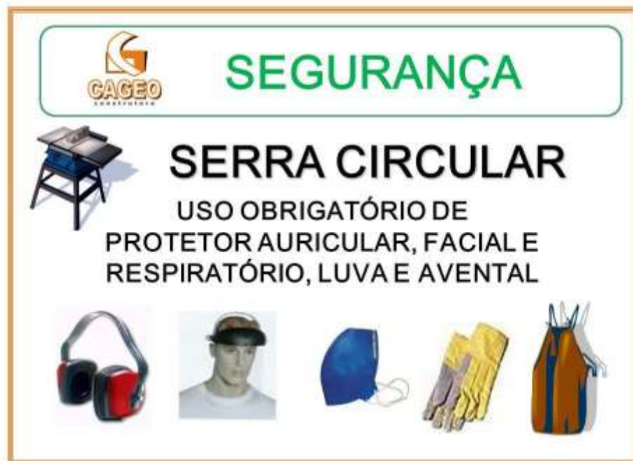
Figura 4. EPI's recomendados durante a operação de serra circular.
