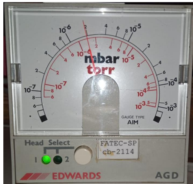
Figura 123: Medida experimental da pressão final no ponto de referência durante o segundo teste de vazamento real nos tubos do sistema tubular.
