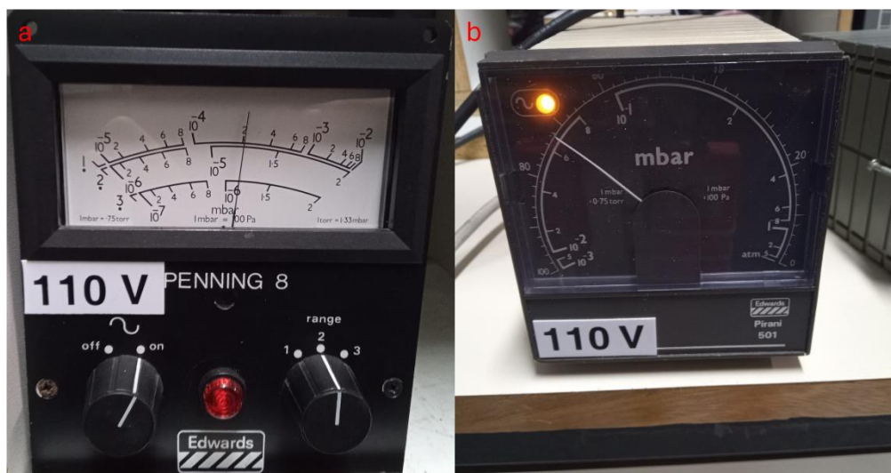
Figura 122: Valores de pressão obtidos durante o primeiro teste de vazamento no tubo 1. a - medição no ponto de referência; b- medição na extremidade do tubo.
