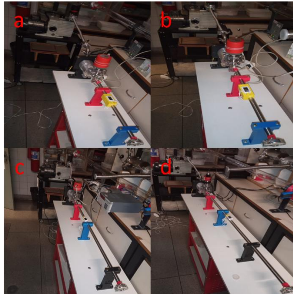
Figura 98: Medições da pressão no ponto de referência de cada um dos tubos do sistema tubular. a- tubo 1; b- tubo 2; c- tubo 3; d- tubo 4.
