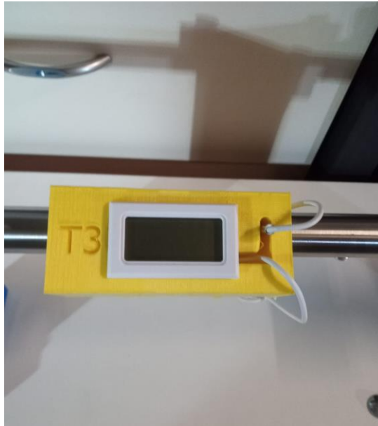
Figura 103: Termopar fixado ao tubo com um suporte para medição da temperatura do tubo.
