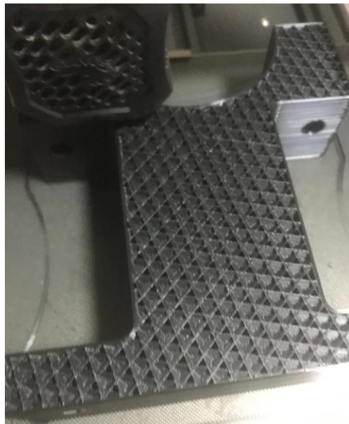
Figura 51: Impressão 3D do suporte da bomba turbo-drag.
