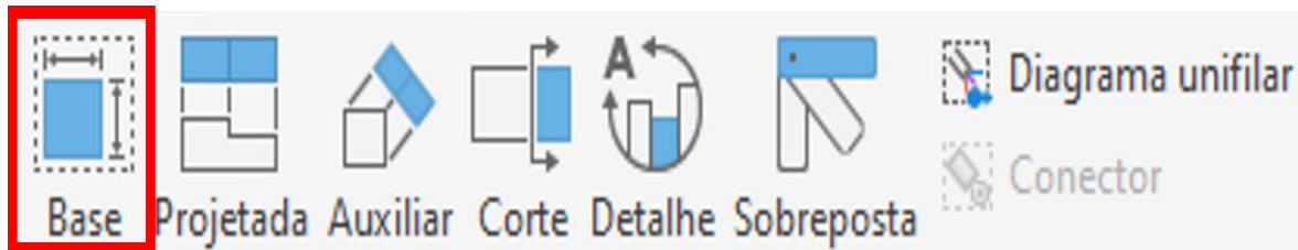
Figura 70: Ícone para importar arquivos CAD para o ambiente de desenho.
