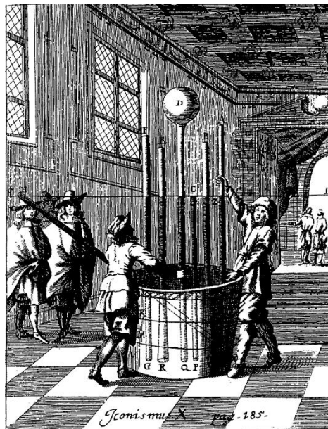
Figura 1: Experiência de Torricelli (1608-1647) demonstrando que a altura da coluna de mercúrio dos tubos unilaterais não dependia da geometria e inclinação dos tubos.
