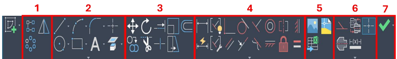
Figura 55: Ferramentas de esboço 2D. 1- Padrões de repetição no plano do esboço; 2- Ferramentas de criação de geometrias; 3- Ferramentas de modificação de geometrias; 4- Restrições do desenho; 5- Exportação de arquivos para o plano; 6- Formato da linha; 7- Finalização do esboço.
