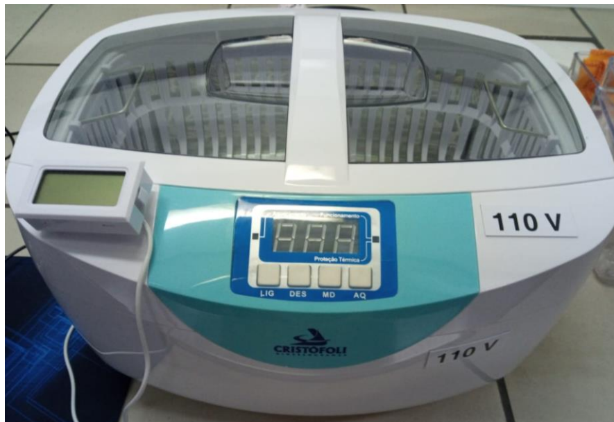
Figura 82: Câmara de ultrassom utilizada para a limpeza ultrassônica das peças.
