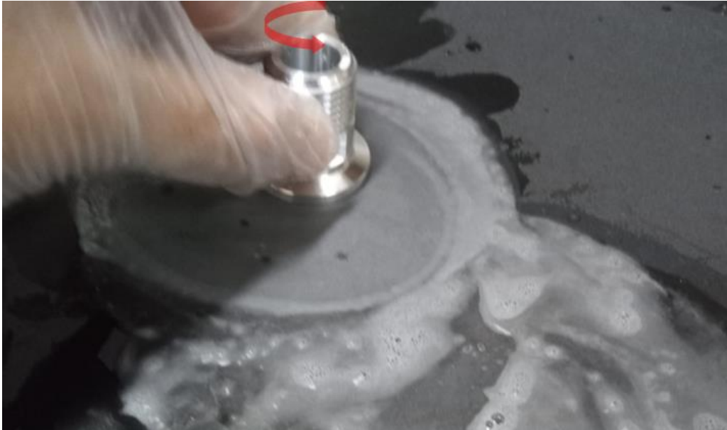
Figura 79: Polimento de uma conexão do sistema.
