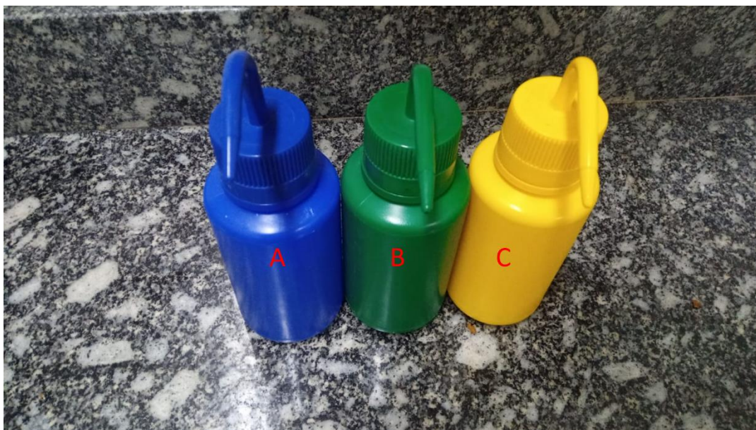
Figura 77: Pissetas com os produtos químicos utilizados no projeto. a- Detergente alcalino; b- Detergente neutro; c- Álcool etílico.
