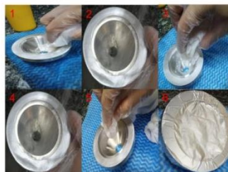
Figura 2 – Etapas de limpeza dos componentes sistema tubular. 1- Detergente alcalino; 2- Enxágue; 3- Detergente neutro; 4- Enxágue; 5- Álcool isopropílico; 6- Embalagem.
