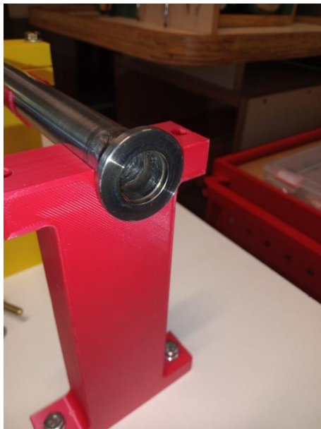
Figura 49: Tubo 4 com uma das suas extremidades soldadas com uma conexão ISO KF 16
