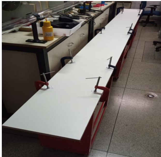
Figura 88: Fixação da mesa aos carrinhos utilizando grampos.
