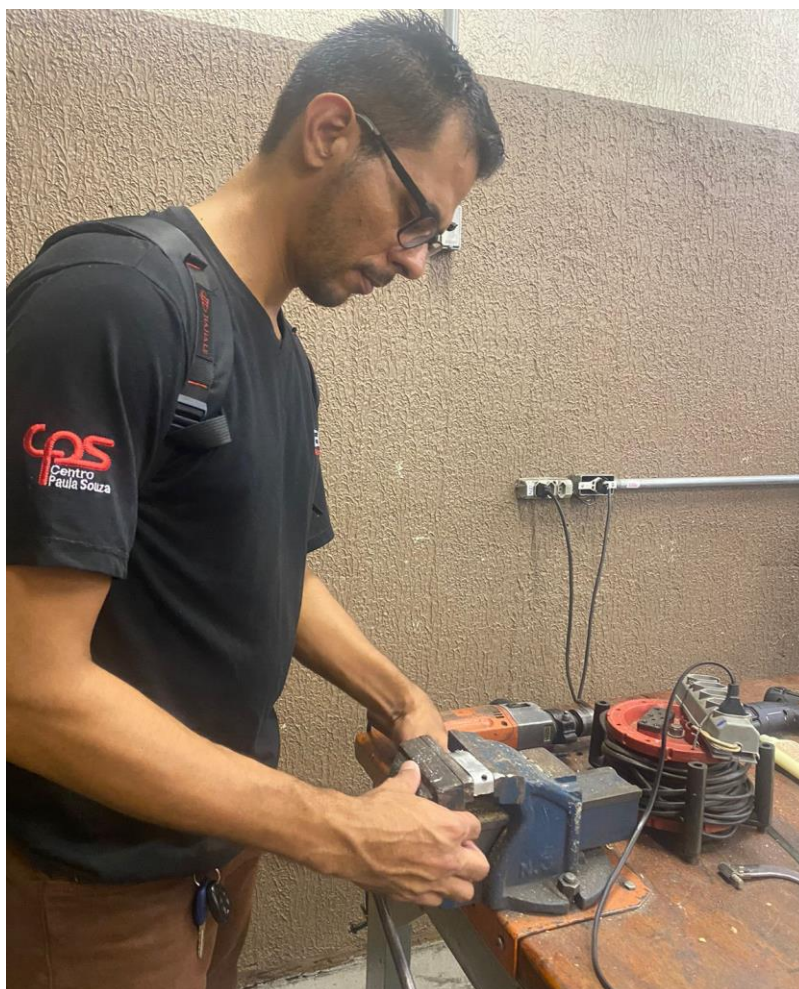
Figura 6: Modelando a cinta de alumínio
