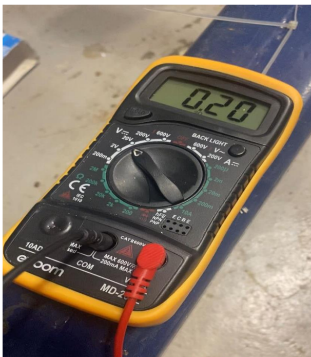
Figura 11: Medindo tensão (Vcc)
