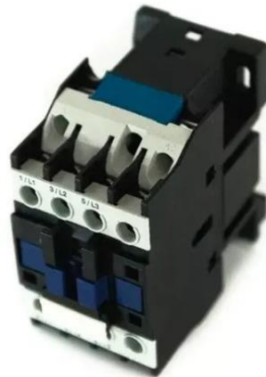
Figura 17– Descrição Modelo: CJX2-0901 Corrente Suportada: 09A Regime Continuo Contatos: 3 contatos + 1 Contatos Auxiliares: 1 Contato Normalmente Fechado Frequência: 60Hz Bobina: 24VAC
