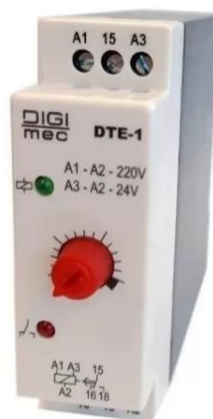
Figura 12- Descrição: Temporizador com a função "RETARDO NA ENERGIZAÇÃO"
