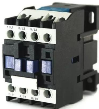
Figura 20 – Descrição: Modelo: CJX2-D0910 Corrente Suportada: 09A Regime Continuo Contatos Auxiliares: 1 Contato Normalmente Aberto Tensão: 24Vac
