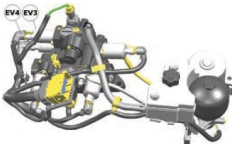
Figura 27 - Posição de montagem das Válvulas EV3 e EV4
