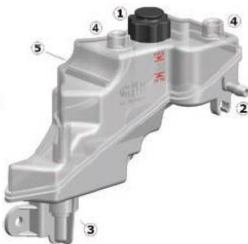
Figura 20 - Reservatório do óleo do conjunto hidráulico
