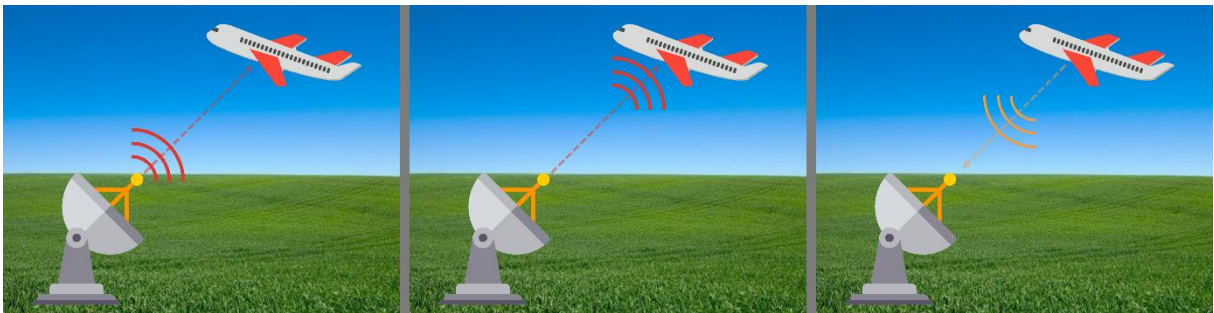
Figura 3: Representação do funcionamento de um radar de pulso
