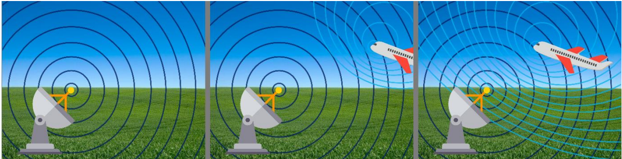
Figura 4: Representação do funcionamento de um radar de onda contínua
