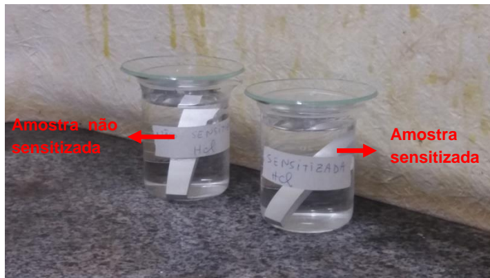
Figura 17 – Teste em ácido clorídrico com concentração de 50% por 24 horas
