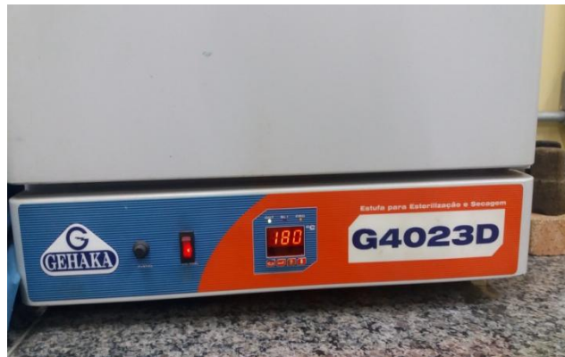
Figura 16 – Tratamento térmico de sensitização entre 60° e 180°C por 72 horas no forno mufla
