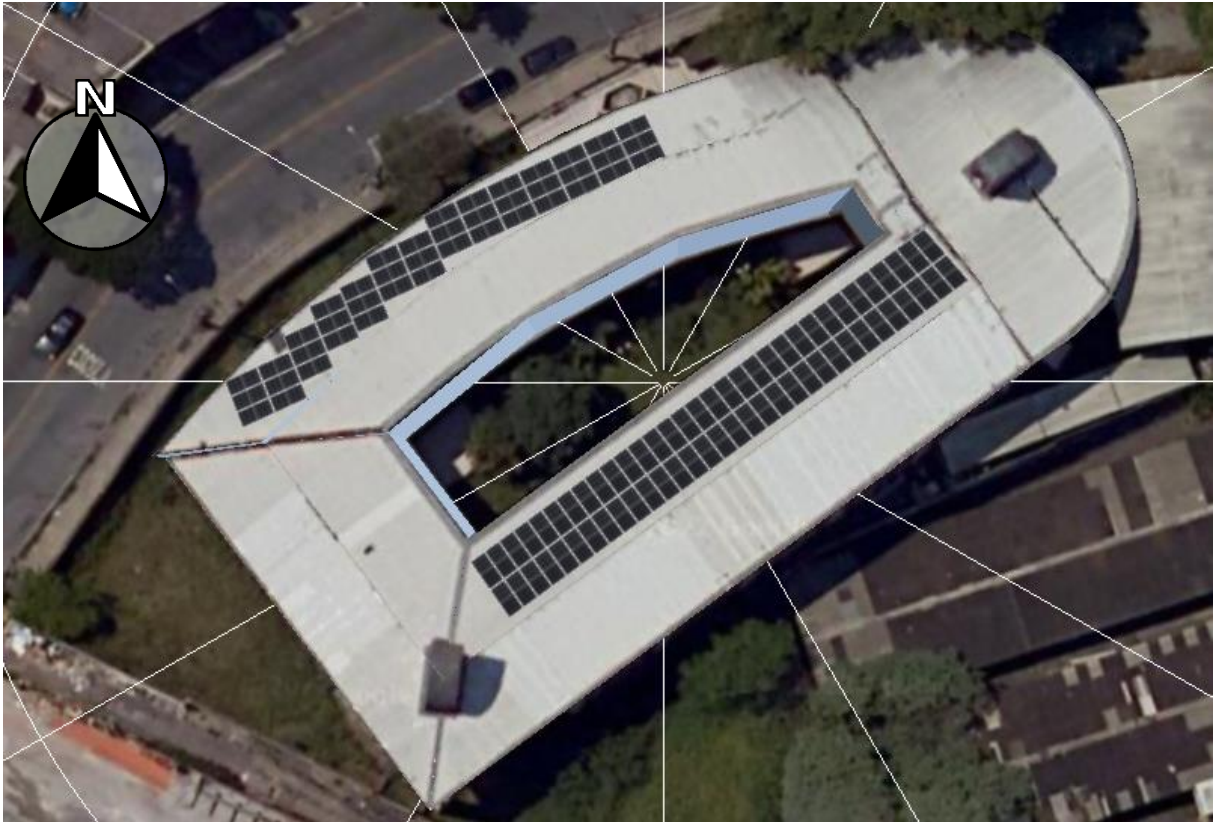
Figura 4. Vista geral (superior) do projeto do Sistema fotovoltaico da ETEC de Guaianazes. Fonte: PV*SOL premium - Os resultados foram determinados com base em um modelo de cálculo matemático da Valentin Software GmbH (algoritmos PV*SOL).
