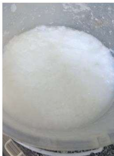
Figura 03: Polpa desagregada de celulose feita após sair do desagregador.
