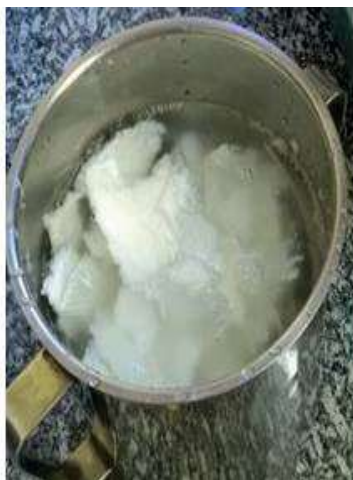
Figura 02: Fibra de celulose e água destilada misturados no copo de alumínio
