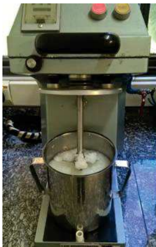
Figura 03: Polpa desagregada de celulose feita após sair do desagregador.
