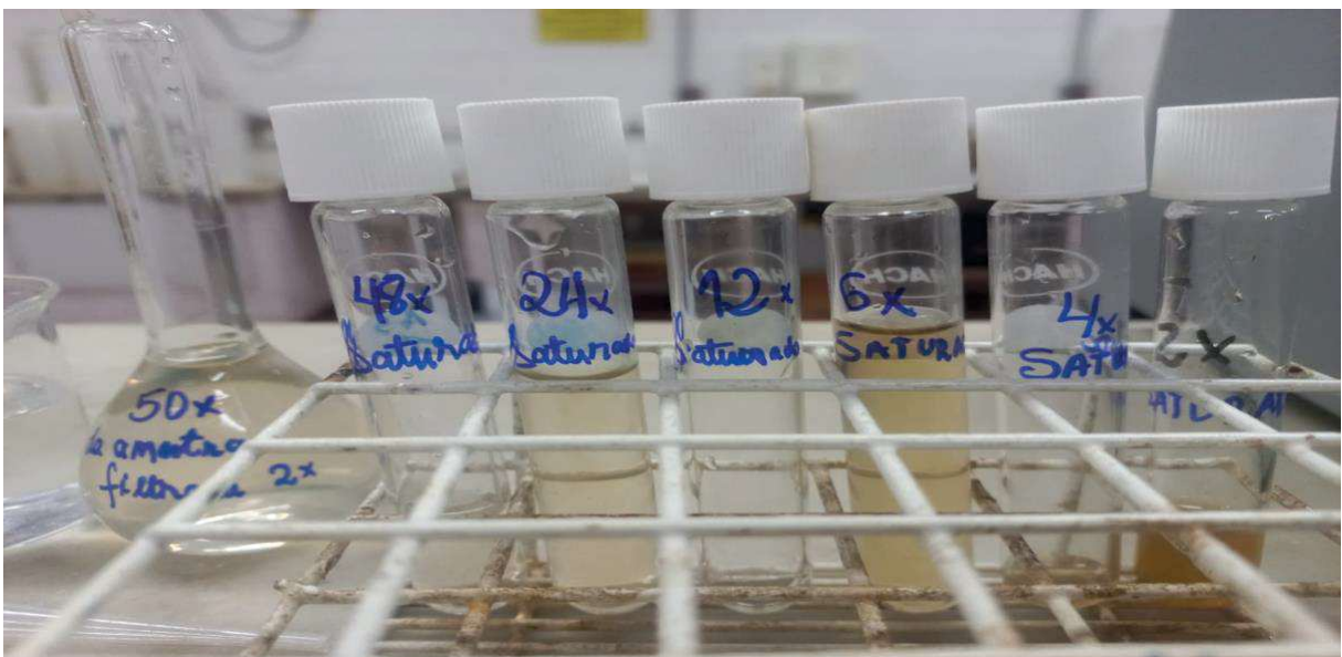
Figura 04. Diluição para amostra do potássio (K).
