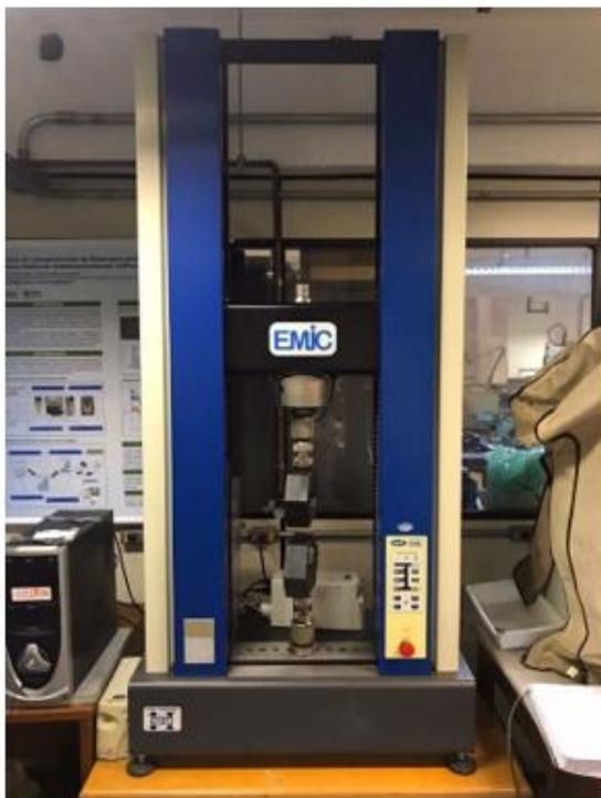
(a) Máquina de Ensaio de Tração EMIC, linha DL 300kN.
