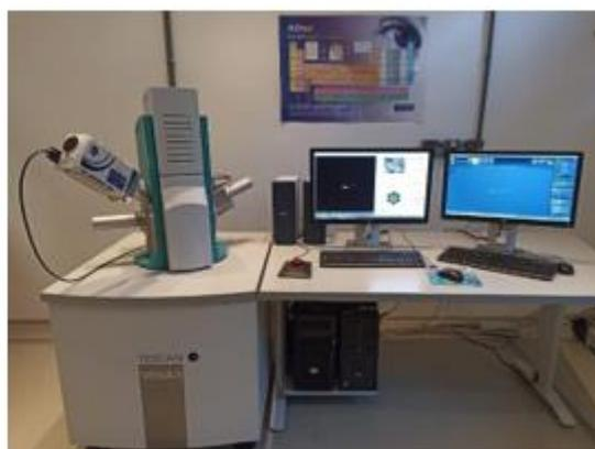
(b) Microscópio eletrônico de varredura com EDS acoplado (MEV/EDS)
