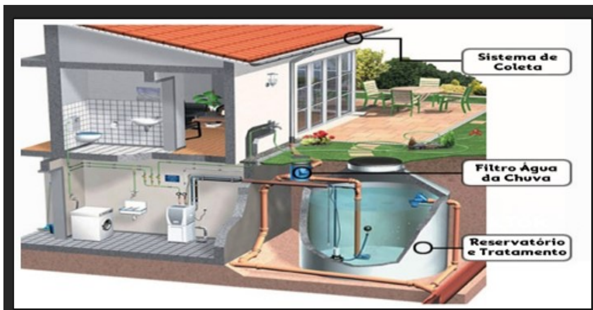
Figura 11 – Sistema de captação da água da chuva.
