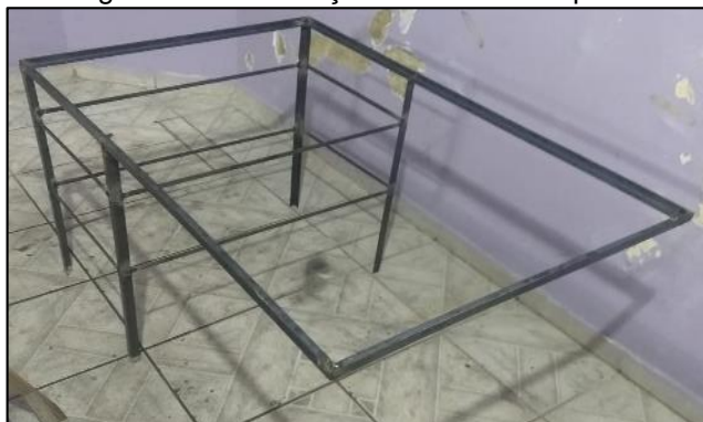
Figura 3.17 – Reforço na estrutura da ponte
