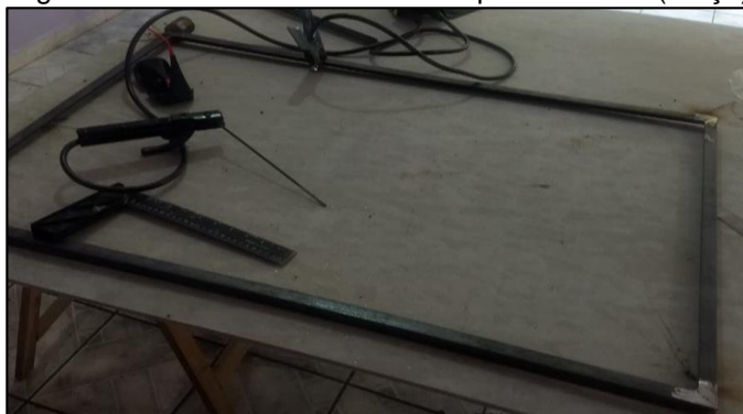
Figura 3.15 – Início da estrutura da ponte rolante (braço)
