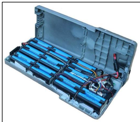
Figura 1.4 – Pack com 40 células de lítio íon usada em e-bike
