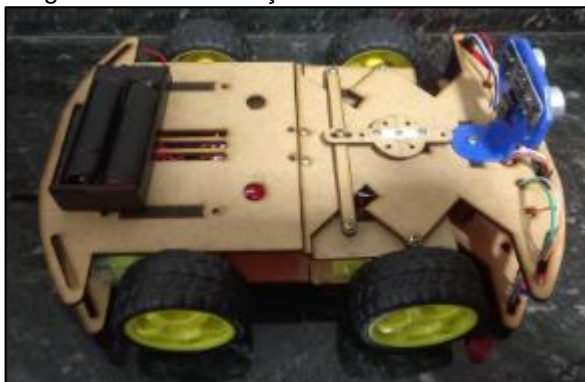
Figura 3.12 – Instalação das baterias no chassi
