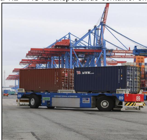
Figura 1.2 – AGV transportando container em porto
